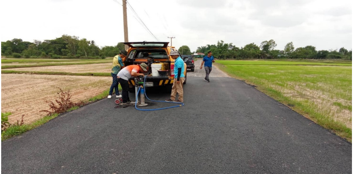
ภาพดำเนินการตรวจสอบความหนาผิวจราจร
